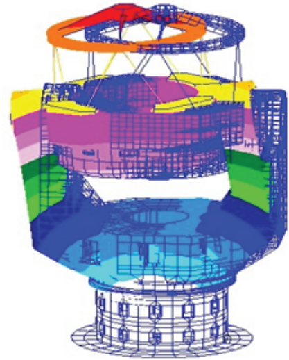
图2 风载引起望远镜抖动的有限元分析结果
