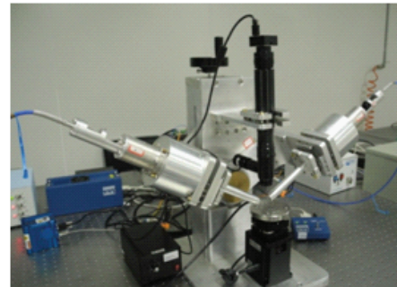
图 1 双旋转补偿器型 Mueller 矩阵椭偏仪基本光路与原理样机
