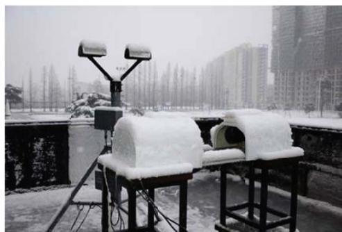
图4 降水微物理特征测量仪的外场试验
