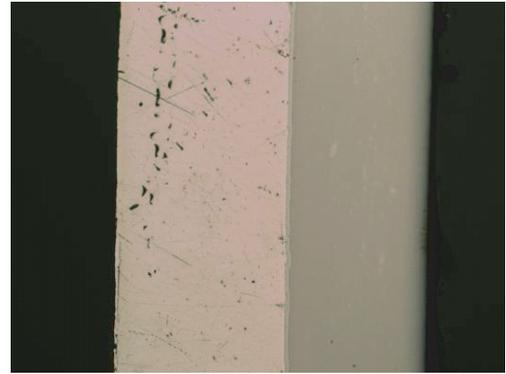
图2 Ti6Al4V/Ly12 Al/聚酰胺纤维密度梯度复合材料样品的断面图
