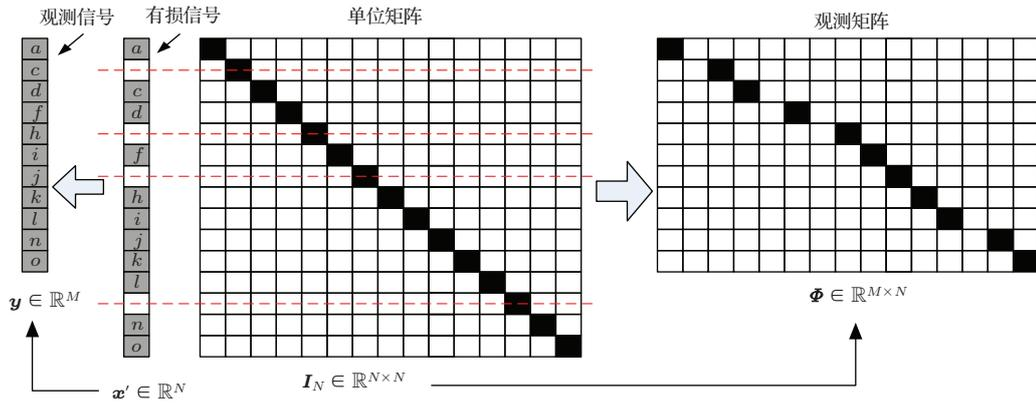
图1 信号  $y$  和矩阵  $\Phi$  的构造示意图
