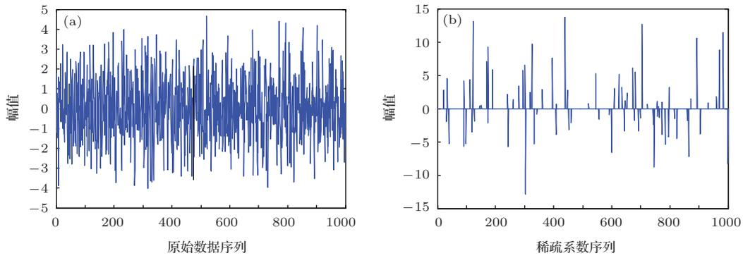
图 2 仿真信号  $x$  (a) 及其对应于 DCT 矩阵的稀疏系数向量  $\Theta$  (b)
