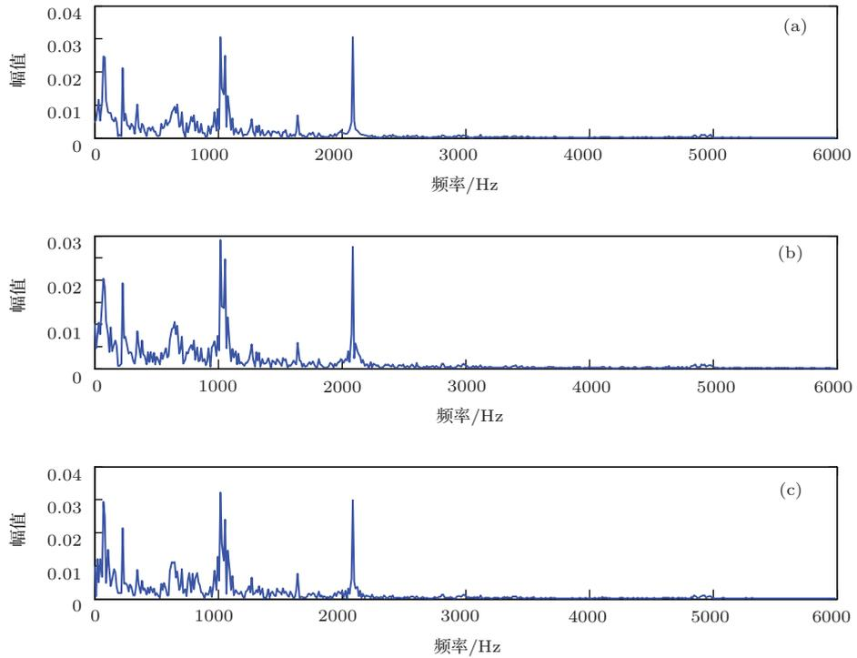
图7 损失100点数据时的振动数据修复结果(频域) (a) 原始信号; (b) 有损信号(损失100点); (c) 修复信号
