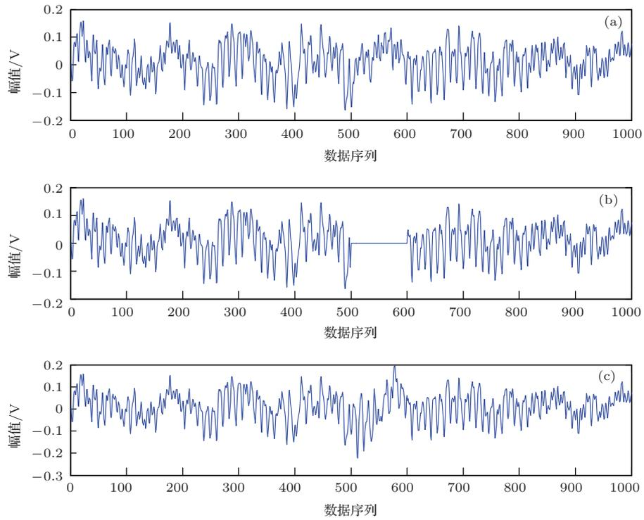
图6 损失100点数据时的振动数据修复结果(时域) (a) 原始信号; (b) 有损信号(损失100点); (c) 修复信号
