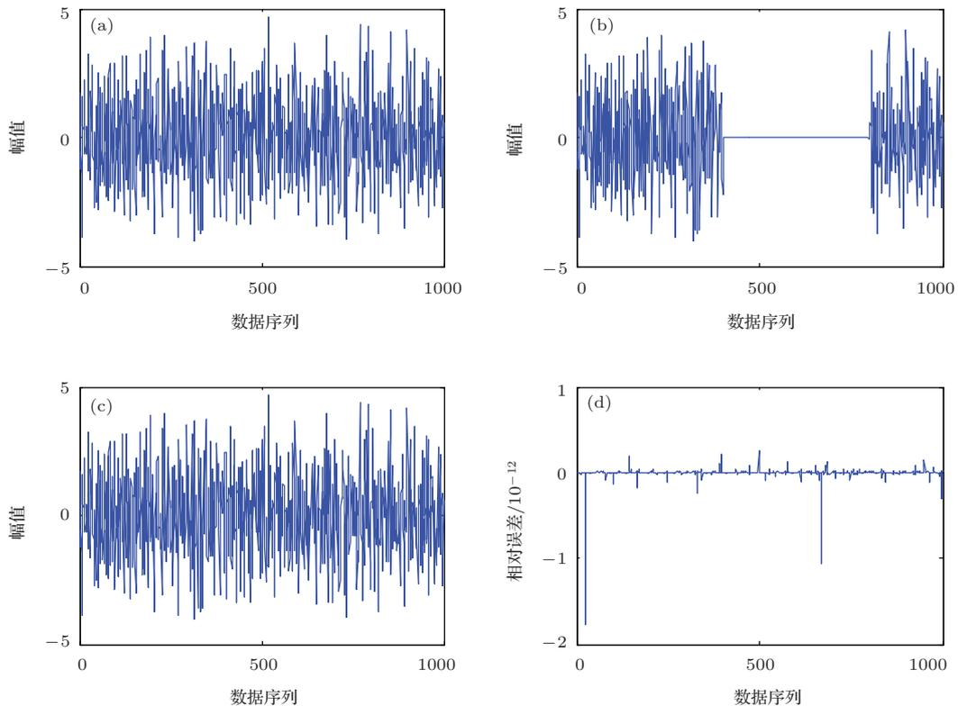
图 3 损失 400 点时的仿真数据修复结果
