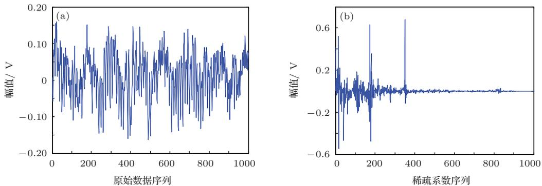
图 5 实测振动信号  $\boldsymbol{x}$  (a) 及其在 DCT 矩阵下的系数向量  $\boldsymbol{\Theta}$  (b)
