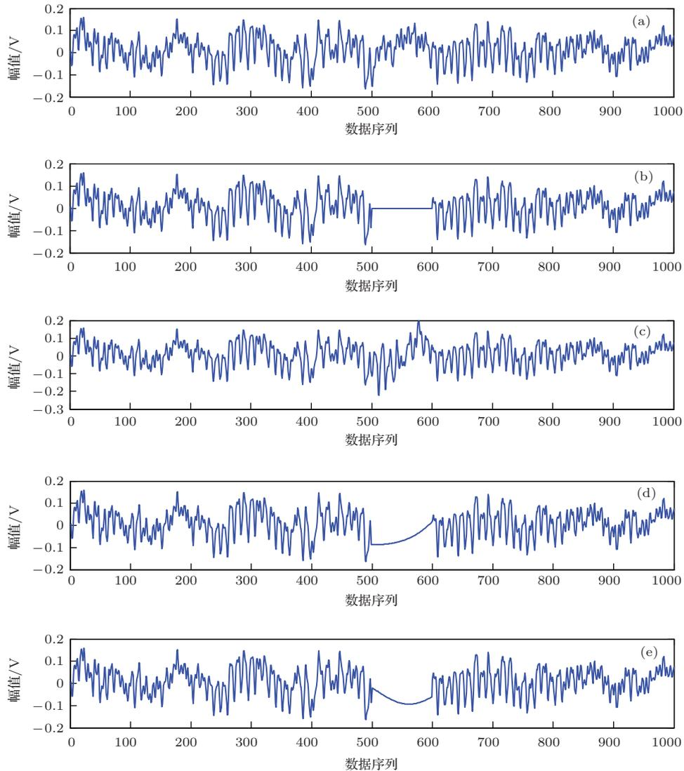
图8 不同方法对应的振动数据修复效果 (a) 原始信号; (b) 有损信号(损失100点); (c) 本文方法修复信号; (d) 三次多项式插值法修复结果; (e) 曲线拟合法(阶数20)修复结果
