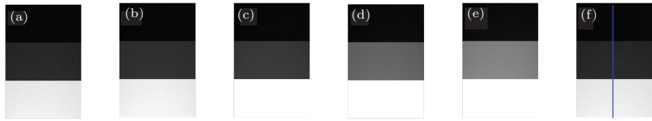
图9 (网刊彩色) 钢阶梯块图像 (a) 75 kV; (b) 85 kV; (c) 95 kV; (d) 105 kV; (e) 110 kV; (f) 融合图像
