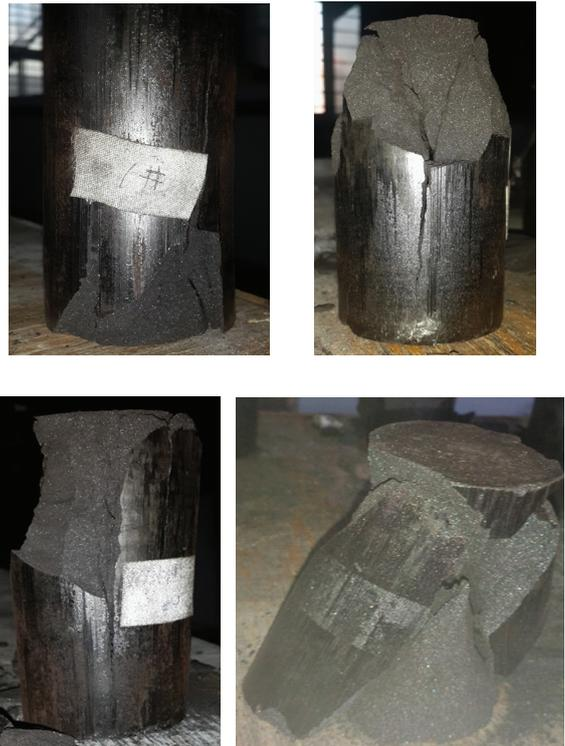
图3 颗粒煤岩试样1#, 2#, 3# 破裂结果及破裂形成的锥形堆
