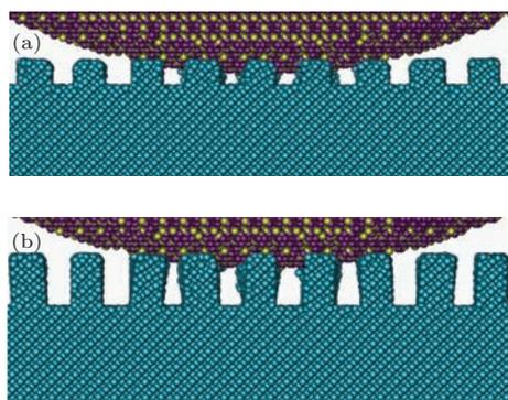
图9 探头与表面D,表面E接触加载过程中 $xy$ 平面的原子构型(压入深度为5 Å) (a)表面D; (b)表面E
