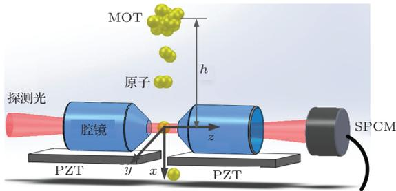
图 1 实验装置简图, 高精细度光学微腔是由放置在片状的压电陶瓷 (PZT) 上的两片超镜组成, 原子通过磁光阱技术被俘获于微腔正上方大约 6 mm 处; 单光子探测器 (SPCM) 用于记录腔的透射信号
