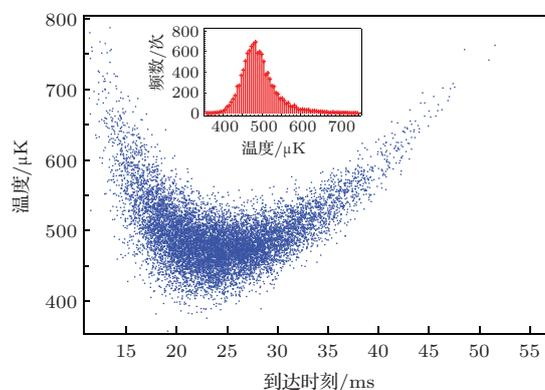
图6 探测到原子的温度与其到达时刻关系的模拟, 内插图表示原子到达腔模的温度的统计分布
