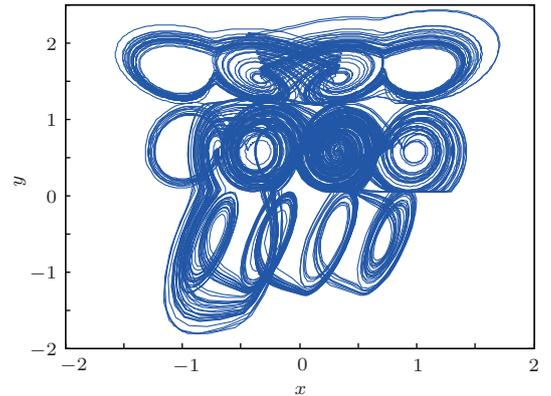
图 8 复合多翅膀 Lorenz-多涡卷 Jerk-多涡卷 Chua 混沌吸引子相图
