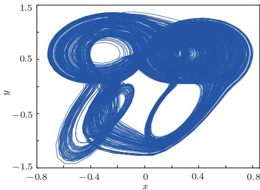
图 1 复合两涡卷 Jerk-Chua 混沌吸引子相图
