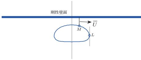
图1 气泡上浮至水平壁面附近
