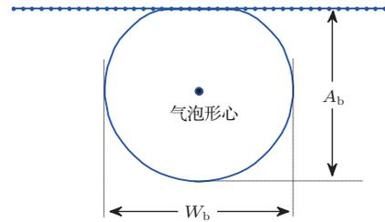
图3 最终气泡形态标注
