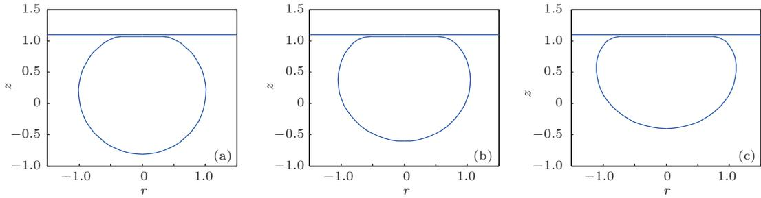
图 11 不同  $We$  数情况下气泡最终平衡形态示意图 (a)  $We = 500$ ; (b)  $We = 3000$ ; (c)  $We = 6000$
