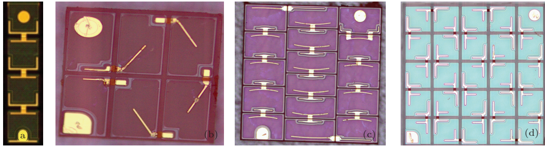
图3 (a), (b), (c), (d) 分别为 12 V, 19 V, 51 V, 80 V 高压 LED 的结构图
