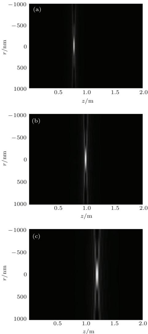
图10 (网刊彩色) 不同曲率半径 Kinoform 单透镜的聚焦光强在透镜后的分布 (a)  $R = 600 \text{ nm}$ ; (b)  $R = 800 \text{ nm}$ ; (c)  $R = 1 \mu\text{m}$
