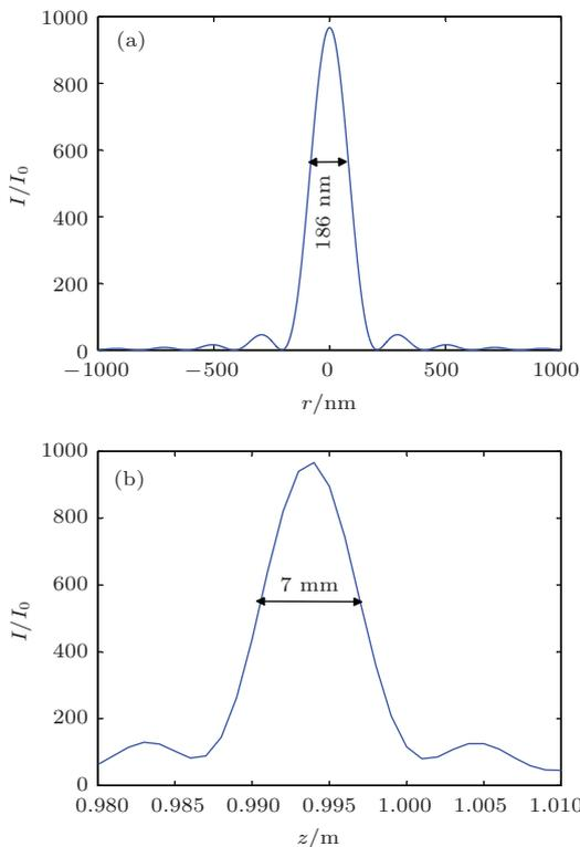
图3 Kinoform单透镜聚焦实例 (a) 焦斑; (b) 焦深
