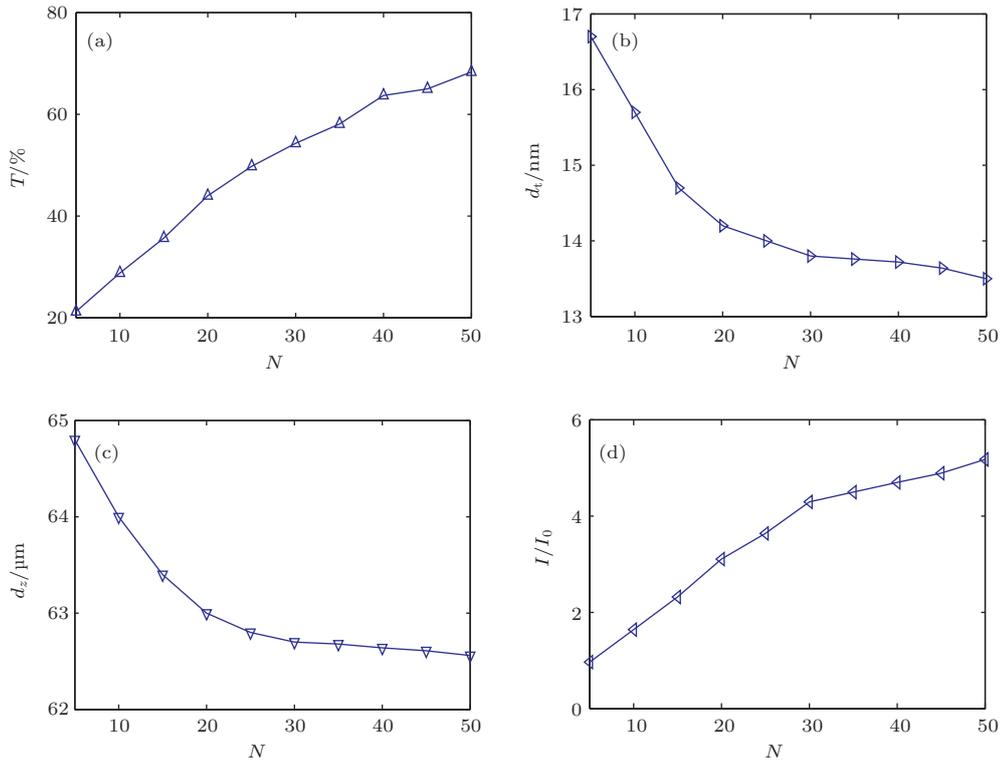
图9 (网刊彩色) Kinoform 单透镜聚焦性能随台阶数的变化 (a) 光强透过率; (b) 焦斑尺寸; (c) 焦深; (d) 增益
