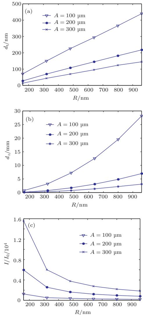
图11 (网刊彩色) 不同孔径 Kinoform 单透镜的聚焦性能随顶点曲率半径的变化 (a) 焦斑; (b) 焦深; (c) 聚焦光强增益
