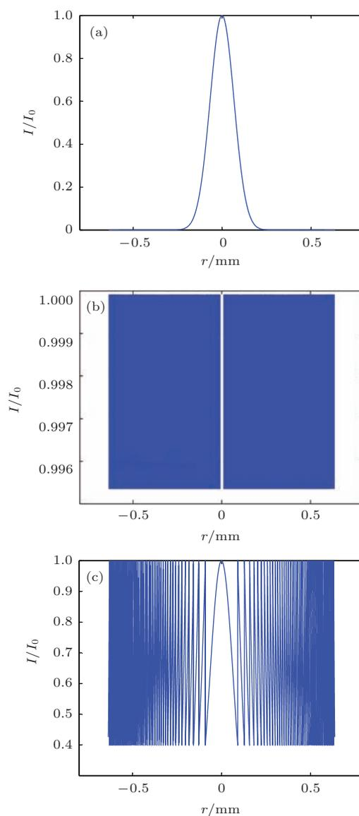
图 7 (网刊彩色) 三种不同设计的光强透过率 (a) 实体透镜; (b) 台阶厚度产生  $2\pi$  位相差的 Kinoform 透镜; (c) 台阶厚度产生  $400\pi$  位相差的 Kinoform 透镜
