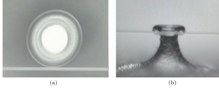
图3 微芯圆环腔与光纤锥耦合 (a) 俯视图; (b) 侧视图
