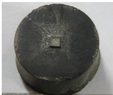
图1 \text{BaFe}_{12}\text{O}_{19} 掺杂量 x = 0.4 \text{ mol\%} 时 Gd123 单畴块材的宏观形貌
