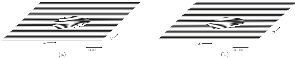
图4 引入液晶 SLM 校正后 5° 和 17° 视场的光瞳图 (a) 5° 视场的光瞳图; (b) 17° 视场的光瞳图
