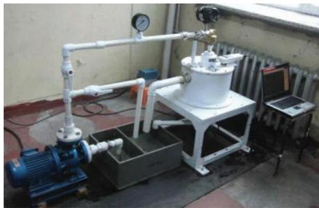
图9 (网刊彩色) 流体摩擦阻力测试实验装置
