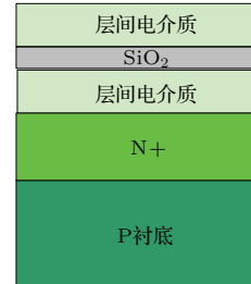
图5 CMOS APS 像素单元各层的简化模型
