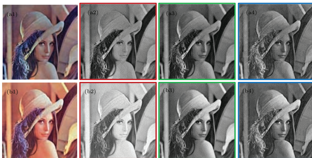
图7 (网刊彩色) 恢复结果 (a1), (b1) 分别为真彩色物体的振幅和相位; (a2)—(a4) 分别为各波长对应振幅; (b2)—(b4) 分别为各波长对应的相位
