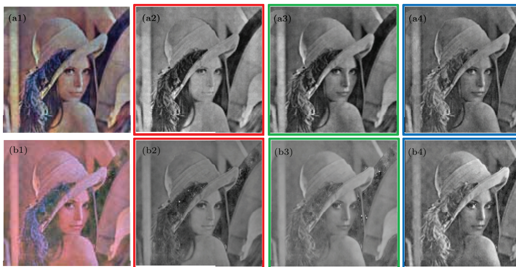
图8 (网刊彩色) 添加10%噪声后的恢复结果 (a1), (b1) 分别为真彩色物体的振幅和相位; (a2)—(a4) 分别各波长对应振幅; (b2)—(b4) 分别为各波长对应的相位
