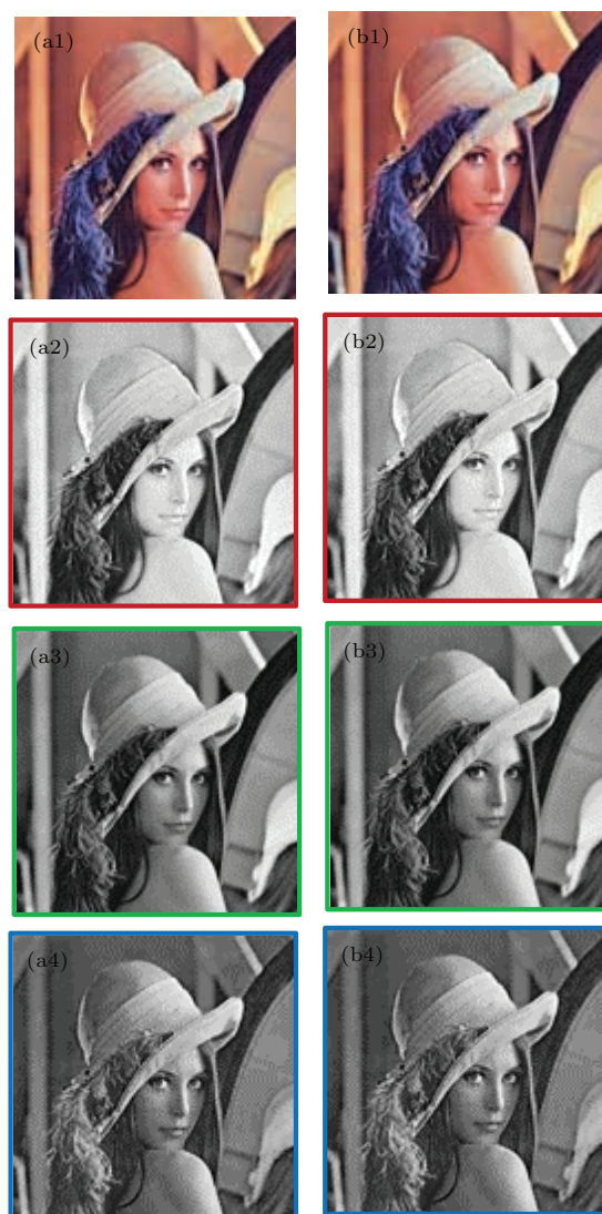
图6 (网刊彩色) 仿真中使用的真彩色物体及相应的光谱响应 (a1), (b1) 分别为真彩色物体的振幅和相位; (a2)—(a4) 分别各波长对应振幅; (b2)—(b4) 分别为各波长对应的相位
