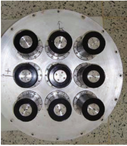
图 3 (网刊彩色) 小尺寸九元矢量平面阵 Fig. 3. (color online) The actual 3 × 3 uniform rectangular array.
