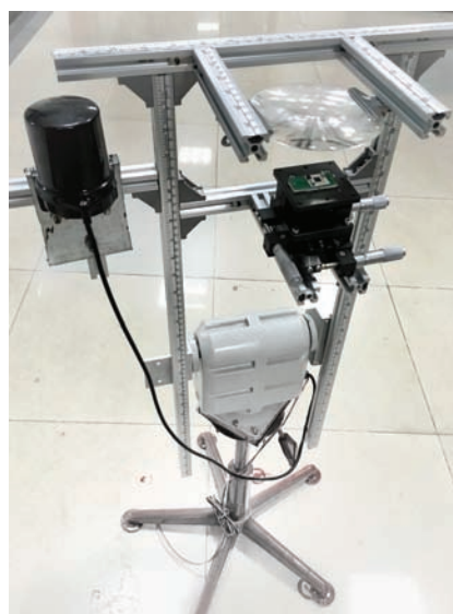
图8 高倍聚光光伏电池室外测试系统
