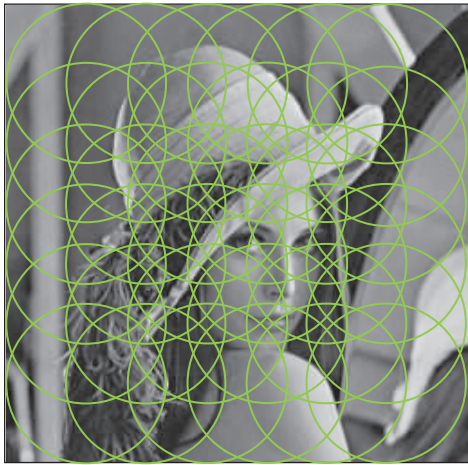
图2 叠层成像算法中各层示意图
