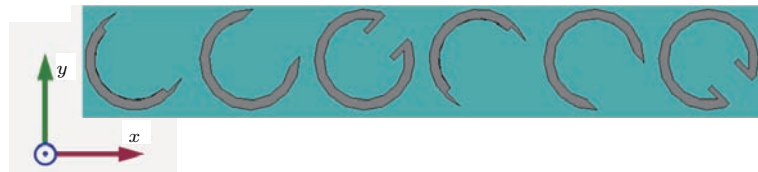
图2 设计的线极化转换相位梯度超表面“超单元”中间层结构图
