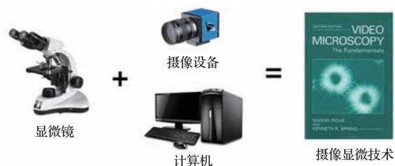
图 1 摄像显微技术的硬件构成: 显微镜, 摄像设备和图像采集及存储的计算机
