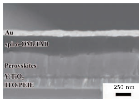
图 8 (网刊彩色) Zhou 等制备的平面太阳能电池的 SEM 图 [30]
