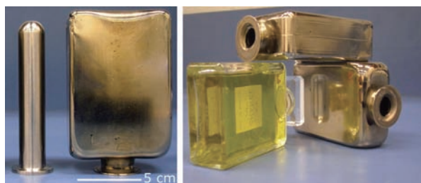
图5 Zr_{44}Ti_{11}Cu_{10}Ni_{10}Be_{25} 金属玻璃通过吹塑成型制得的容器 [23]
