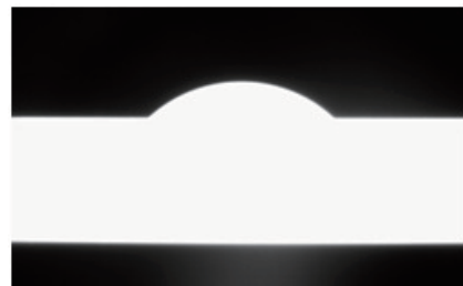
图1 1737 K 温度下未抛光石墨基底上熔融硅液滴轮廓图
