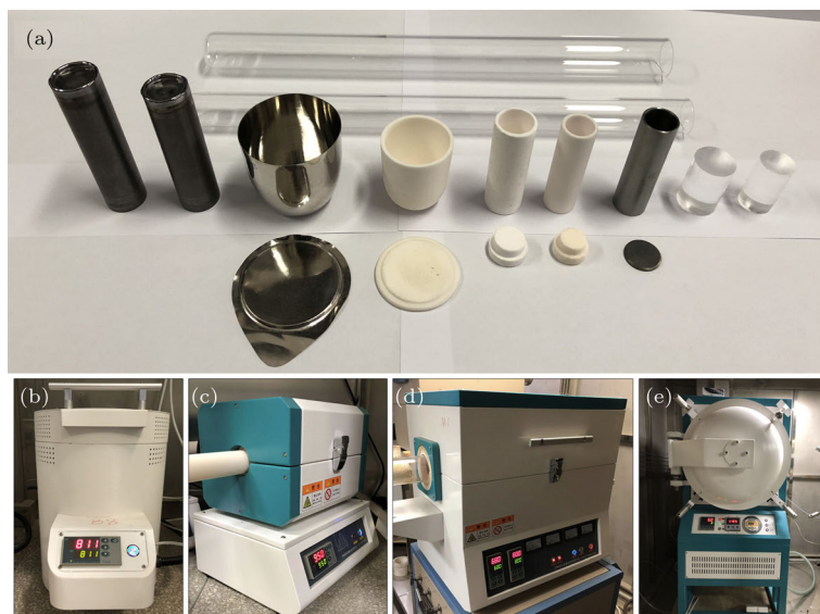
图 1 用于生长单晶的各种坩埚、石英管以及电炉 (a) 由左至右依次为 Ta 管、Pt 坩埚、氧化铝坩埚、Mo 坩埚以及石英柱和石英管; (b)–(e) 分别为井式炉、单温区管式炉、双温区管式炉及气氛保护炉
