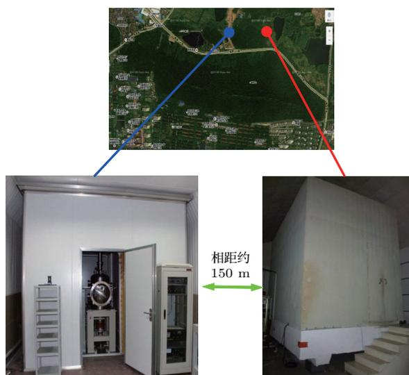
图 10 两套周期法测  $G$  装置
