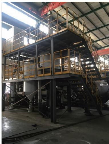
图 3 自主设计的第三代 EIGA 制粉生产设备
