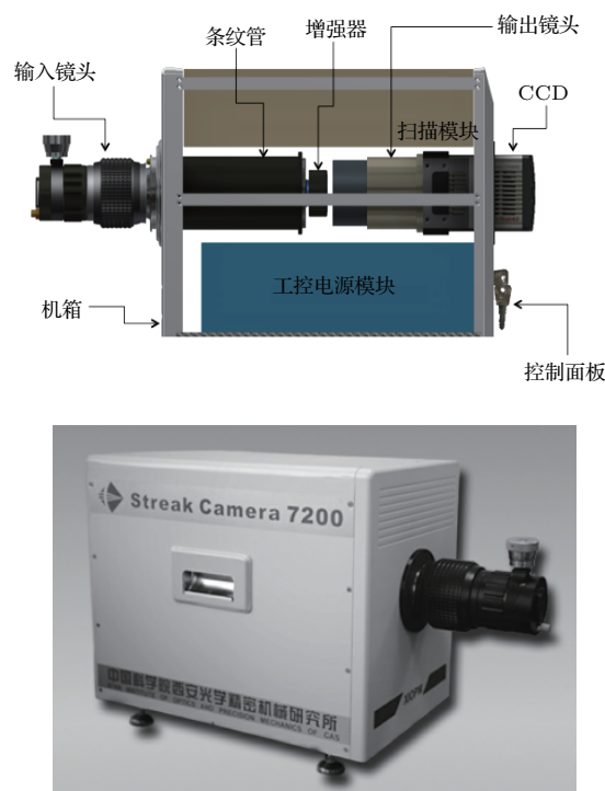
图 1 小型条纹相机结构及实物图
