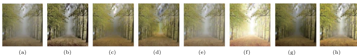
图9 雾天图像增强对比 (a) 雾天图像; (b) 文献[6]算法; (c) 文献[16]算法; (d) 文献[18]算法; (e) 文献[21]算法; (f) 文献[29]算法; (g) 文献[30]算法; (h) 本文算法
