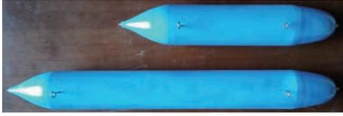
图1 两个细长体模型照片 (model B, model C)
