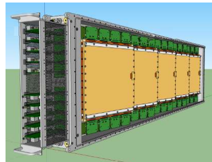
图 12 由 5 个 MRPC 和相应电子学组成的飞行时间探测器模块
