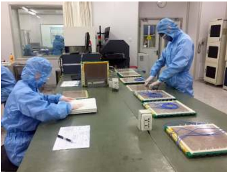
图 14 同方威视公司密云生产车间正在进行高计数率 MRPC 的批量生产
