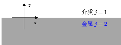
图 2 支持 SPP 传输的金属-介质界面示意图
