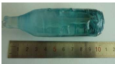
图 1 尺寸为 \text{O}30 \text{ mm} \times 70 \text{ mm} 的 Ti:MgAl 2 O 4 晶体
