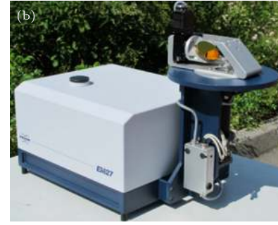
图 1 (a) 观测站点位置 (拉萨市气象局); (b) 观测设备 (傅里叶变换光谱仪, EM27/SUN) Fig. 1. (a) Observing site (Lhasa meteorological bureau); (b) FTIR spectrometer (EM27/SUN).
