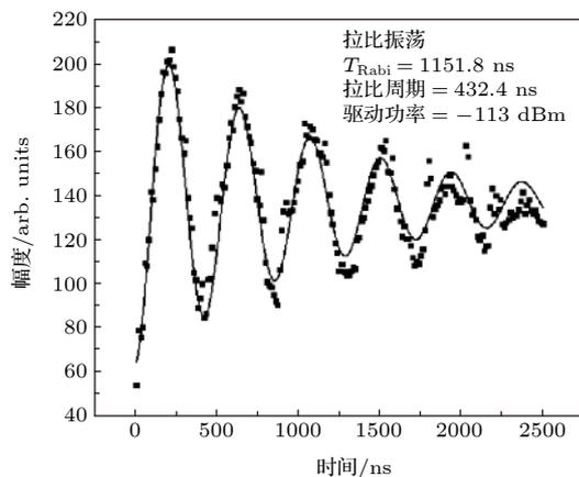
图7 数据采集卡 Jaynes-Cummings 方法测试拉比振荡
