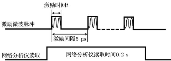
图 4 网络分析仪测量相干振荡时序图
