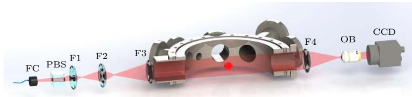
图 1 成像光路示意图. 其中符号的含义为 FC: 光纤耦合头, PBS: 偏振分束器, F1—F4: 透镜, OB: 5\times 成像物镜, CCD: 电荷耦合器件.
