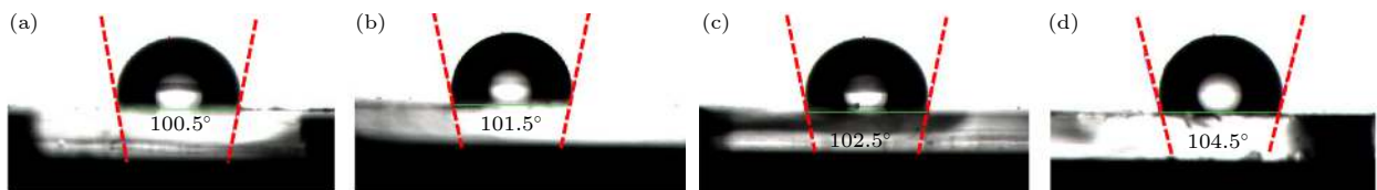
图 4 活性层薄膜水接触角测试, 其中 Y6 质量占比分别为 (a) 0, (b) 10%, (c) 20% 和 (d) 30%
