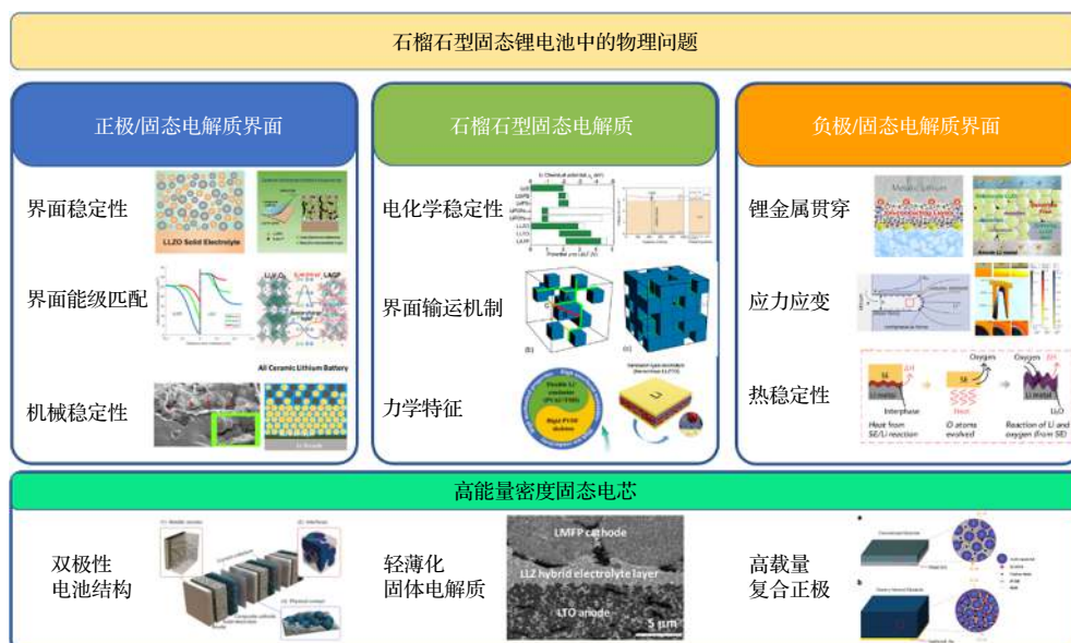
图 14 石榴石型固态锂电池中的关键物理问题(内嵌图出自参考文献)
