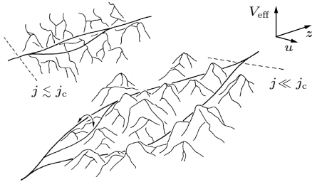
图13 集体钉扎情况下,非线性 U(j) 关系来源示意图.当外电流 j 与临界电流 j_c 接近时,最可能跳跃的长度是一个较短的集体钉扎长度 L_c ,此时的热激活能比较小.当外电流远远小于临界电流时,最佳的跳跃方式是一段较长(长度为 L )的磁通束从外电流中获取更大的能量,然后跳跃一个相对较高的势垒 U ,而 L/L_c > j_c/j .因此热激活跳跃的最可能的长度或体积将会随着洛伦兹力(或电流)的变化而非线性变化.该图取自文献 [21]
