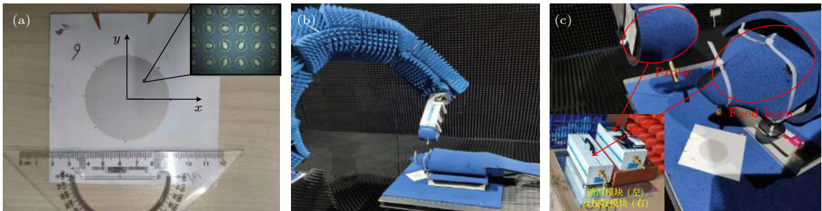
图 7 (a) 加工的超表面; (b) 测试环境; (c) 测试中的超表面
