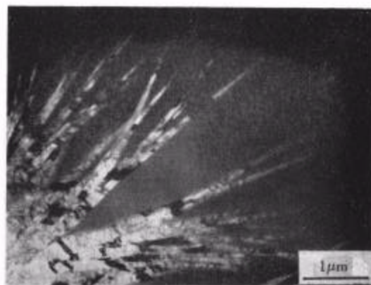
图 1 六角亚稳相 \alpha_2 的生长形态
