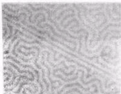
图 5 样品磁畴照片 \times 100
