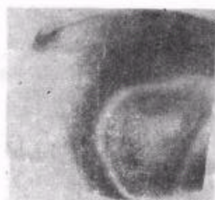
图10 薄膜的双晶反射形貌图 \times 3.5 \text{FeK}\alpha_1 ; 曝光 20h
