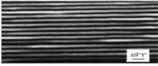
图7 a-Si(20 nm)/SiN x (20 nm)多层膜化学腐蚀 10 s 后的表面结构 SEM 图
