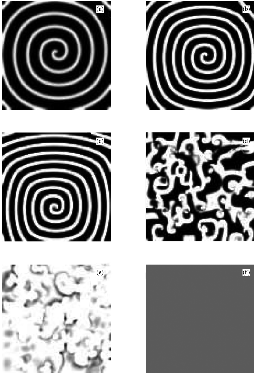
图2 不同相压缩限下系统变量( u 变量)的最终空间分布 系统参数 a = 0.84 , b = 0.07 , \varepsilon = 0.04 , 系统尺寸 L = 100 . (a) 未加控制时, 系统表现为稳定的螺旋波; (b) u_0 = 0.9 , 初始螺旋波受到影响; (c) u_0 = 0.8 , 螺旋波的中心发生移动; (d) u_0 = 0.7 , 螺旋波失稳, 系统的最终演化结果为时空湍流态; (e) u_0 = 0.66 , 系统的时空湍流态; (f) u_0 = 0.6 , 系统进入均匀定态
