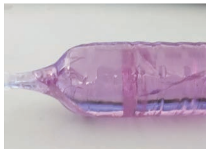
图1 (网刊彩色) 提拉法生长的(1.5 at.%) Nd:YSAG晶体 Fig. 1. (color online) (1.5 at.%) Nd:YSAG crystal grown by Czochralski method.
