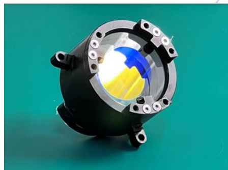
图15 用于CH 4 探测的F-P干涉仪
