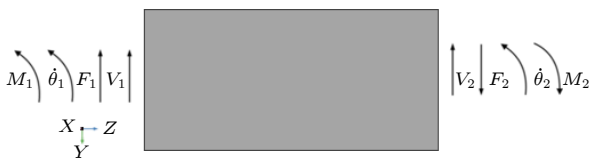
图 1 弯曲振动等截面金属梁边界条件
