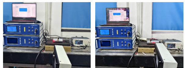
图 17 弯曲振动实验样品振动测试实验装置
